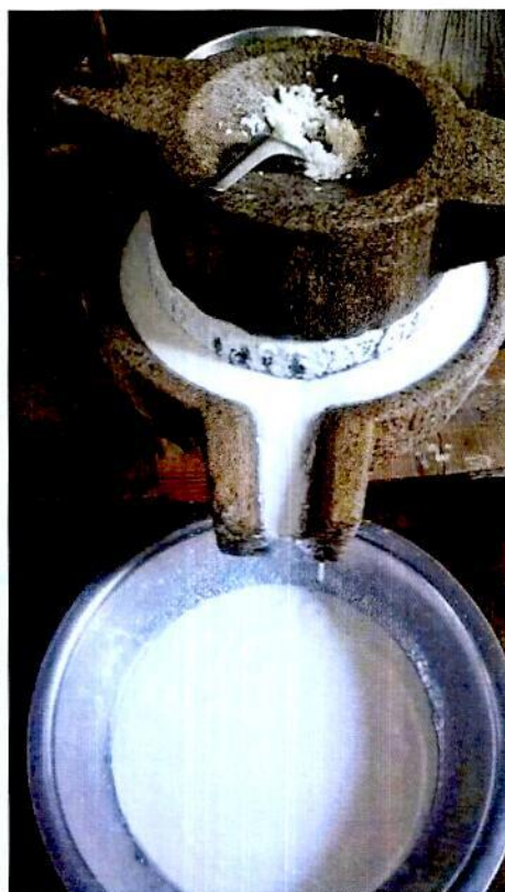
Hình 6. Cối đá dùng để xay bột nước
